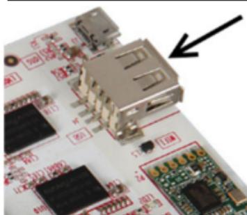
Eine Tastatur / Maus kann an dem USB-Anschluss verwendet werden. Bei Bedarf kann man auch einen USB-HUB eingesetzt, um mehrere Anschlüsse zu erhalten.
