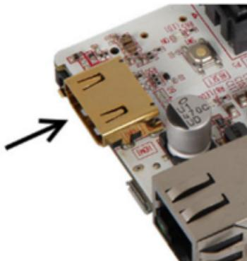
Um eine Bildausgabe zu bekommen, schließen Sie ein HDMI-Kabel zwischen Ihren Bildschirm und dem gekennzeichneten HDMI-Anschluss an.
