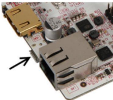
Der pcDuino benötigt für seinen Betrieb eine 5V / 2A Spannungsversorgung, die an dem gekennzeichneten Micro-USB Anschluß angeschlossen werden muss.
