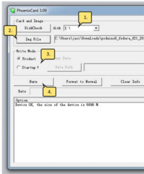
Um den pcDuino mit einer Firmware zu bespielen, müssen Sie eine microSD-Karte mit der entsprechenden Image-Datei mit Hilfe des Programms Phoenix-Card vorbereiten.
