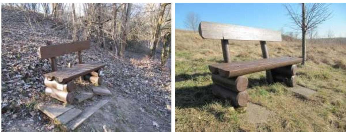
Links die Bank im Zaufensgraben, Station 5, am Aufstieg zur Gartenanlage. Rechts die Bank am Fahrweg zur Gartenanlage zum Geiersberg zwischen der Station Feldraine und Zschippern. Diese Bänke werden durch Steinplatten unter den Holzteilen gegen Fäulnis geschützt.
